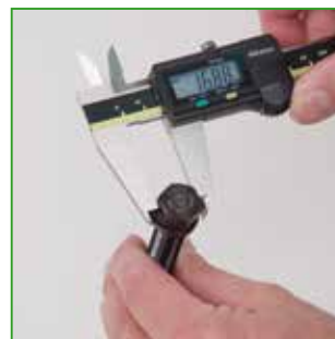
d Измерить шестигранник головки шпинделя.
