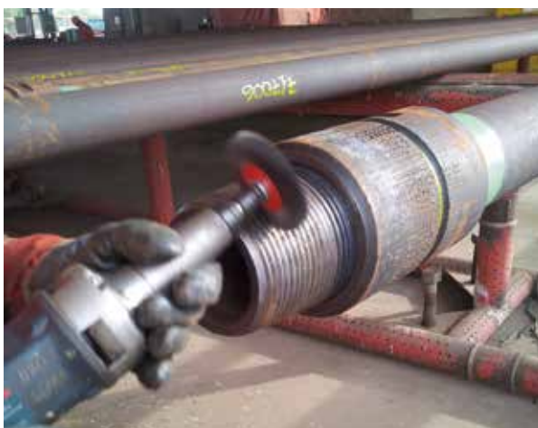
Очистка буровых колонн с помощью проволочных щеток
