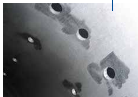
Отверстия охлаждения в корпусе щетки
