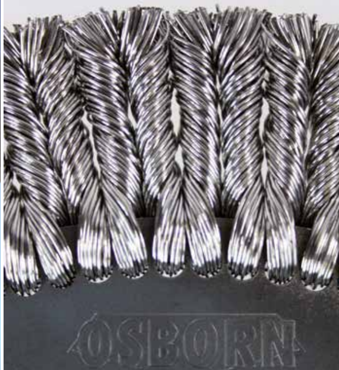
Секция щеток с ворсом, скрученным по часовой стрелке/против часовой стрелки
