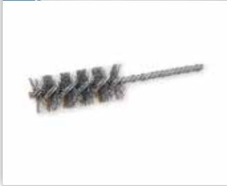
Удаления заусенцев на поперечных отверстиях, деталей управления, пазах для уплотнительных колец цилиндрических отверстий. Рекомендация: Щетка должна быть больше 10-15%, чем размер отверстия.
