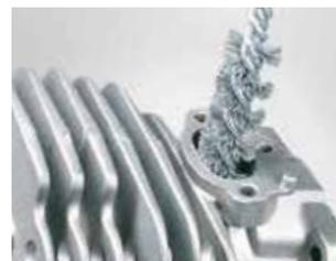
Микроабразивная щетка д/внутр. обработки
