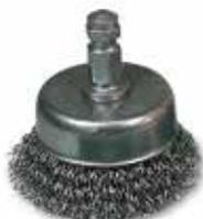
Дисковая щетка D50, быстрозажимаемый хвостовик, гофрированная стальная проволока 0,30, нейтральная / без упаковки, макс. 4 500 об/мин
