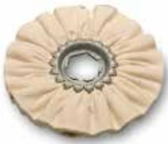
Материал зафиксирован на зазубренном металлическом кольце. Матерчатый полировальный круг закреплен с помощью конических пружинных шайб.
