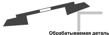
Этот тип применяется в основном для обработки кромки и труднодоступных мест.
